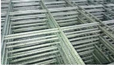
弊社の鉄筋格子は、JIS G 3551(溶接金網及び鉄筋格子)に適合しています。JIS G 3112(鉄筋コンクリート用棒鋼のSD295A)に適合した異形棒鋼を使用し、徹底した品質管理下で生産されているため材質及び規格サイズは安定し正確です。鉄筋工事を簡素化し、施工精度の向上を図る最適な合理化製品となっております。
