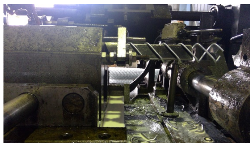
写真2 ひし形金網製造中
