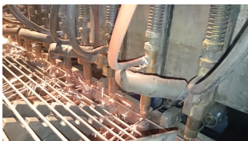
写真1 溶接金網製造中
